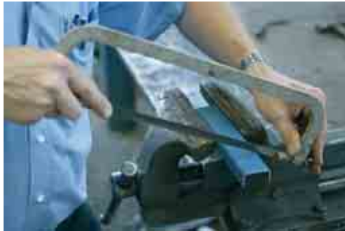
Fig. 2.4 Niet aan de voorkant, maar aan de achterkant van het werkstuk beginnen!
