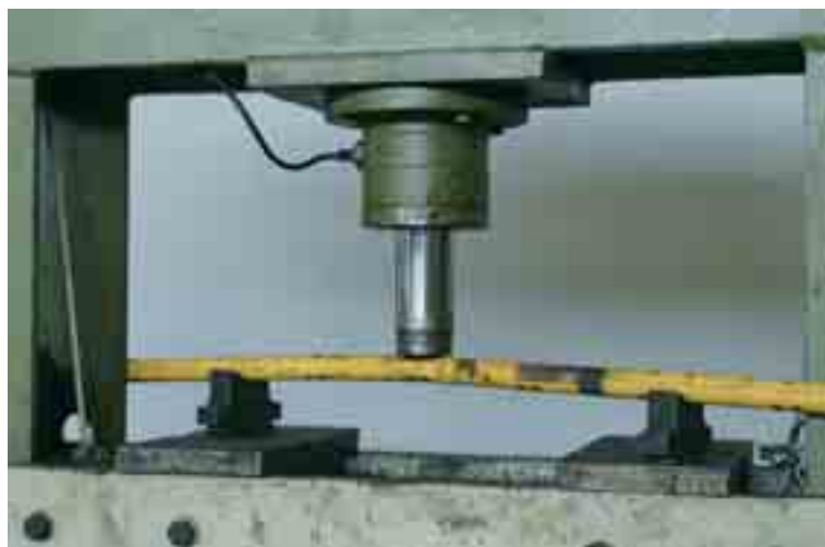
Fig. 8.6 Het te buigen gedeelte moet tussen de V-vormige steunblokken liggen.
