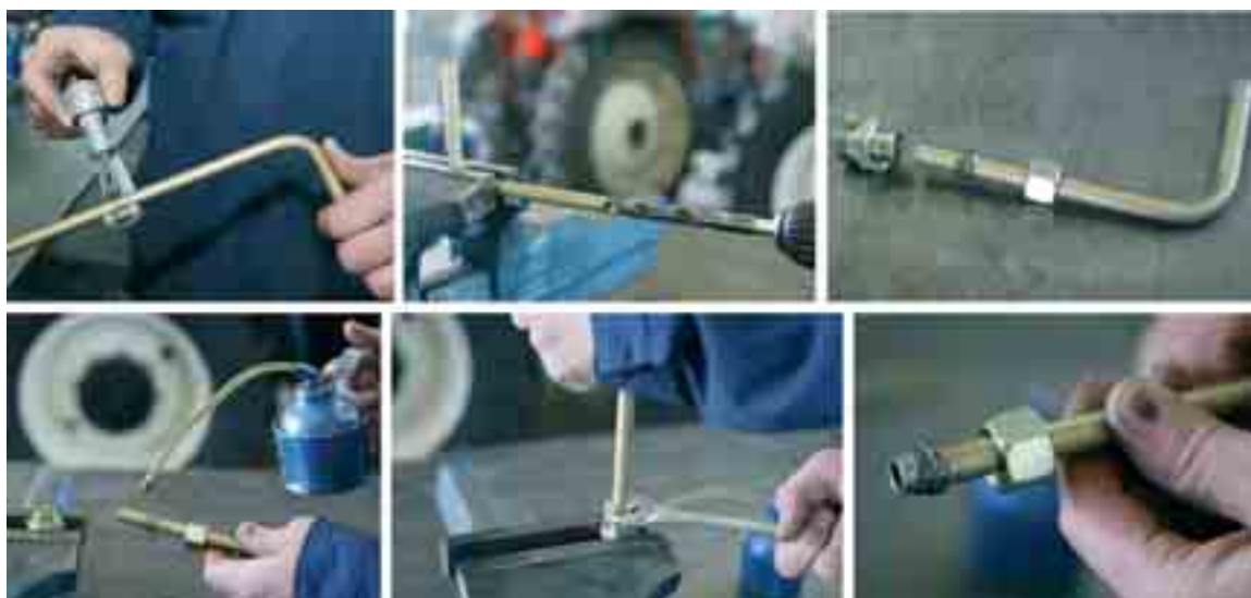
Fig. 13.5 Koppeling aan een leiding zetten
