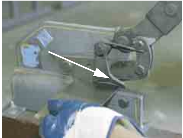
Fig. 5.4 Goed afgestelde tegenhouder voorkomt schuin snijden
