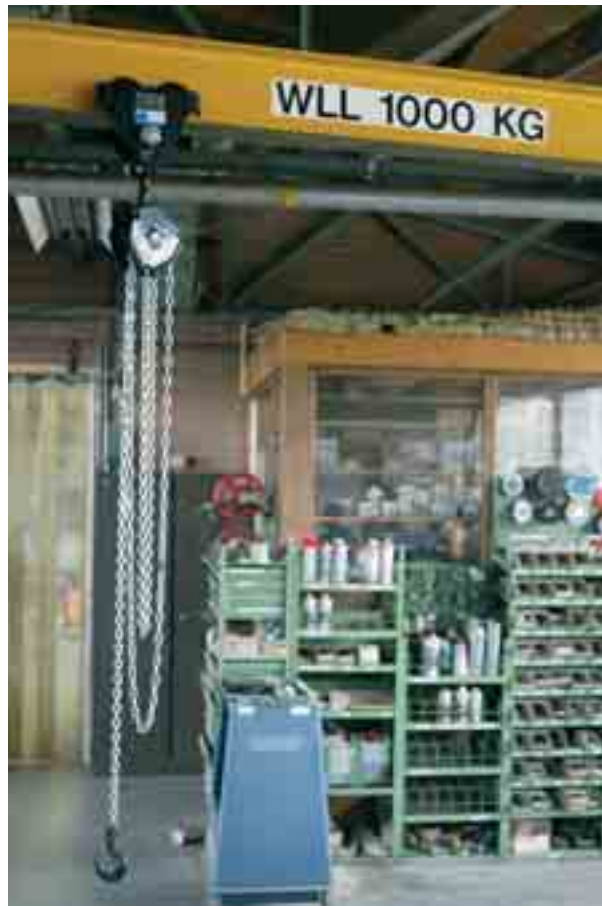
Fig. 14.2 Loopkat met daaraan een ketting bediende takel
