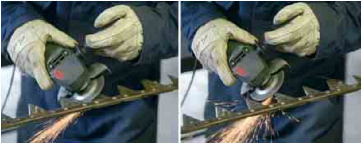
Fig. 4.9 Bij het slijpen met een speciale slijpmachine kun je de hoek exact instellen.
