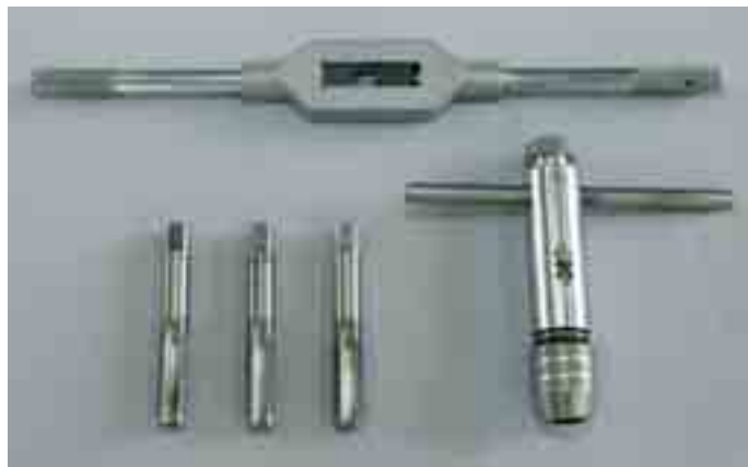
Fig. 3.4 Voor het indraaien van draadsnijtappen gebruik je een wringijzer.
