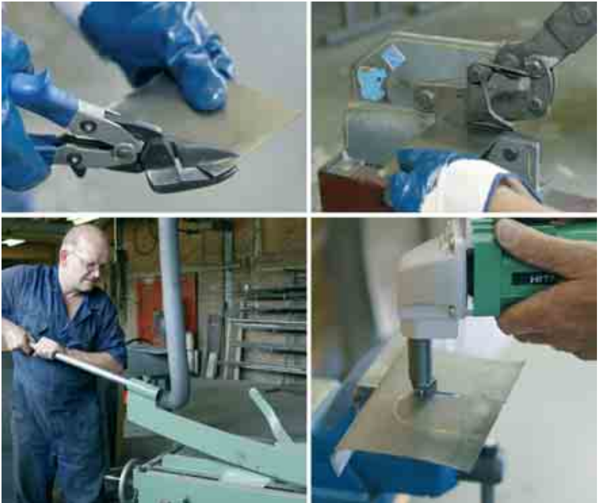
Fig. 5.2 Een handschaar voor kleine stukjes in dun materiaal, een tafelschaar voor plaatmateriaal in dun materiaal, een hefboomschaar voor dikker plaatmateriaal en strips tot ongeveer 10 millimeter en een elektrische handknabbelschaar voor materiaal tot 3 millimeter
