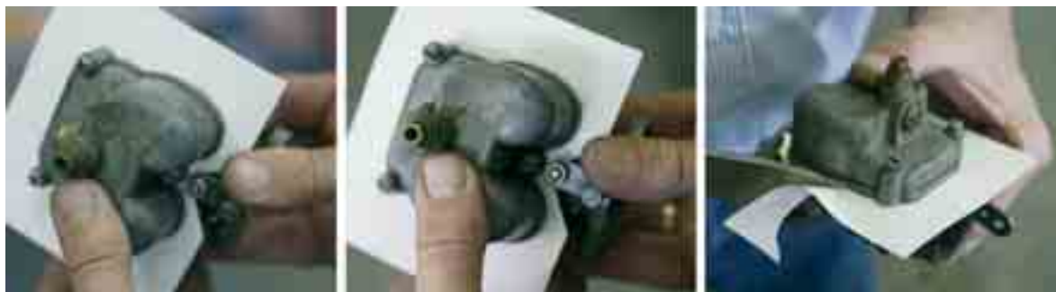
Fig. 9.3 Het maken van een pakking met een smalle rand
