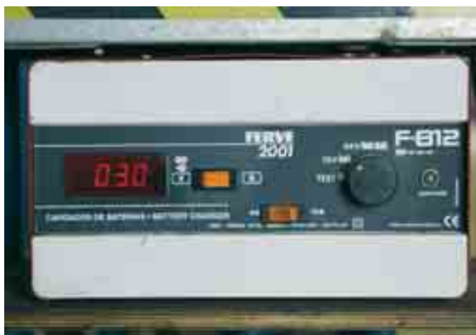
Fig. 14.18 Een acculader met een digitaal afleesbare ampèremeter
