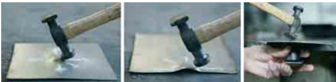
Fig. 8.3 De techniek van het slaan bij het uitdeuken van een plaatje ijzer
