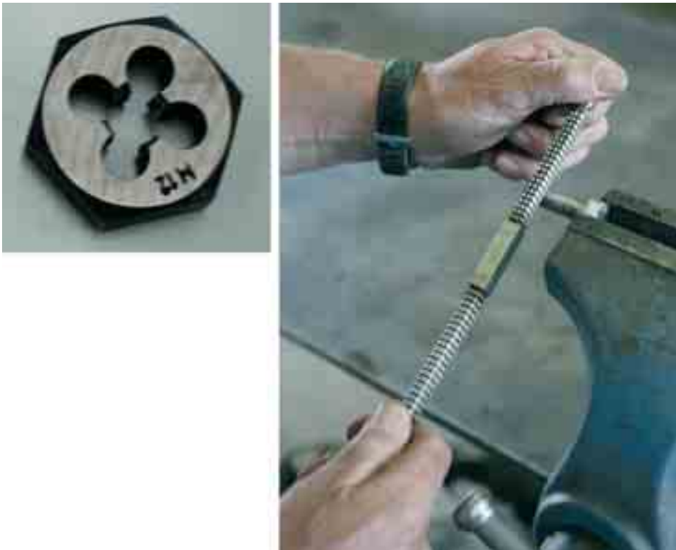
Fig. 3.5 Een draadsnijmoer (links) en een schroefdraadvijl (rechts)
