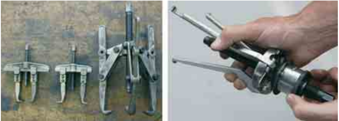
Fig. 14.8 Een tweepunts- en een driepuntstrekker (links) en een verstelbare driepuntsbinnentrekker
