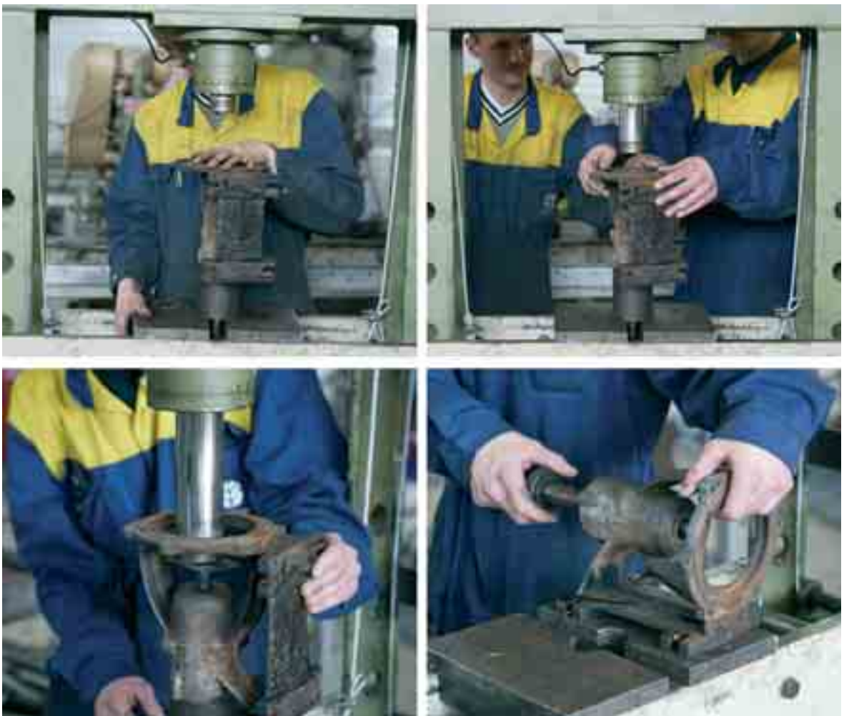
Fig. 14.16 Met behulp van een hydraulische pers wordt een as uit een huis met lager gedrukt.
