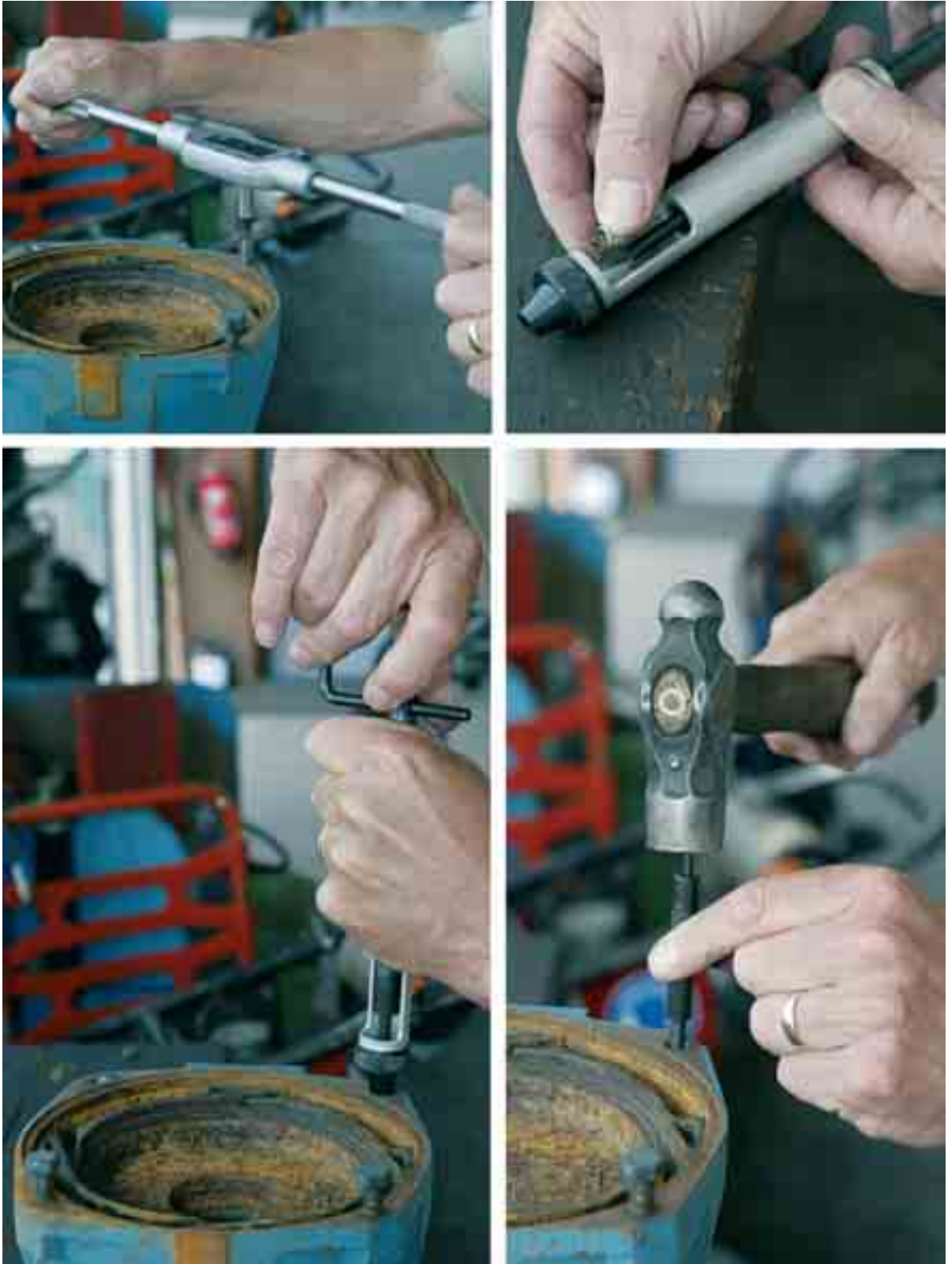
Fig. 3.9 Het tappen van nieuw schroefdraad (linksboven), het plaatsen van de helicoil (rechtsboven), het indraaien van een helicoil (linksonder) en het afbreken van de lip (rechtsonder)
