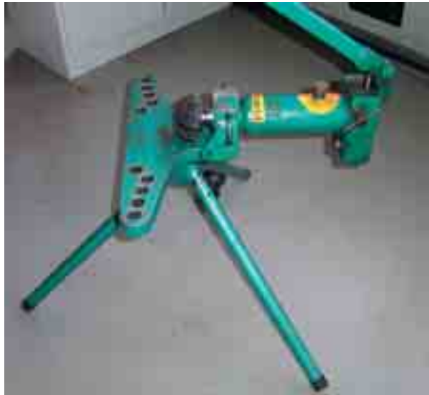
Fig. 6.2 Een pijpenbuigmachine wordt gebruikt voor dikke of zware pijpen.
