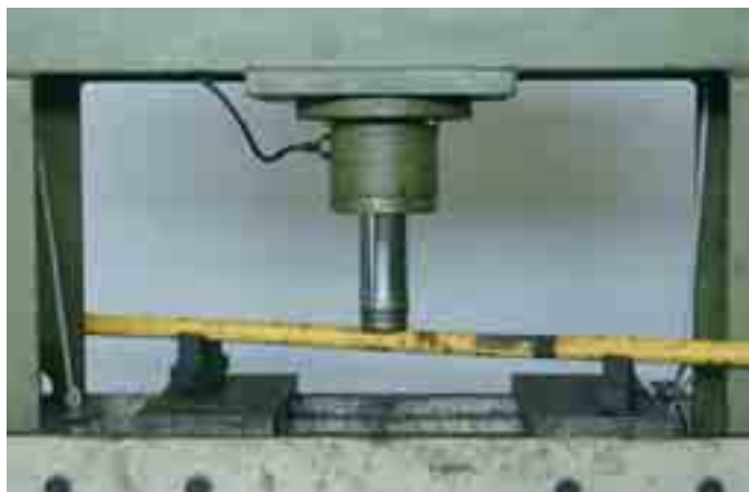
Fig. 8.1 Een as die zojuist recht is gebogen onder een hydraulische pers
