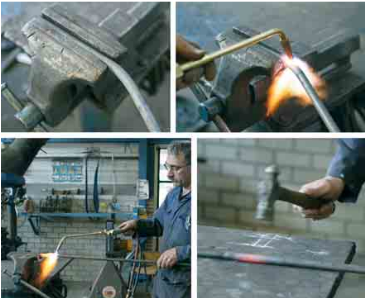
Fig. 8.7 Kromme staaf ijzer in de bankschroef die verhit wordt en uiteindelijk weer recht wordt.
