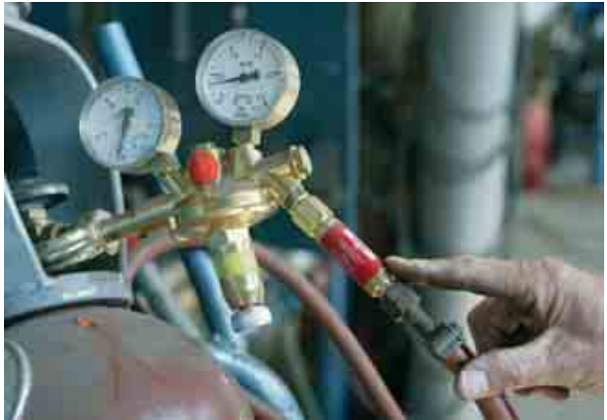
Fig. 7.3 Het reduceerventiel met vlamdover
