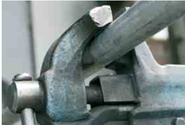
Fig. 3.6 Speciaal klemgedeelte voor pijpen in de bankschroef en het snijden van schroefdraad
