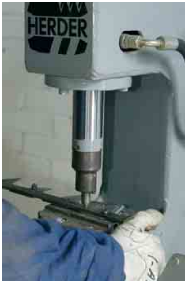
Fig. 10.4 Een hydraulische pers voor het verwijderen en klinken van mesjes
