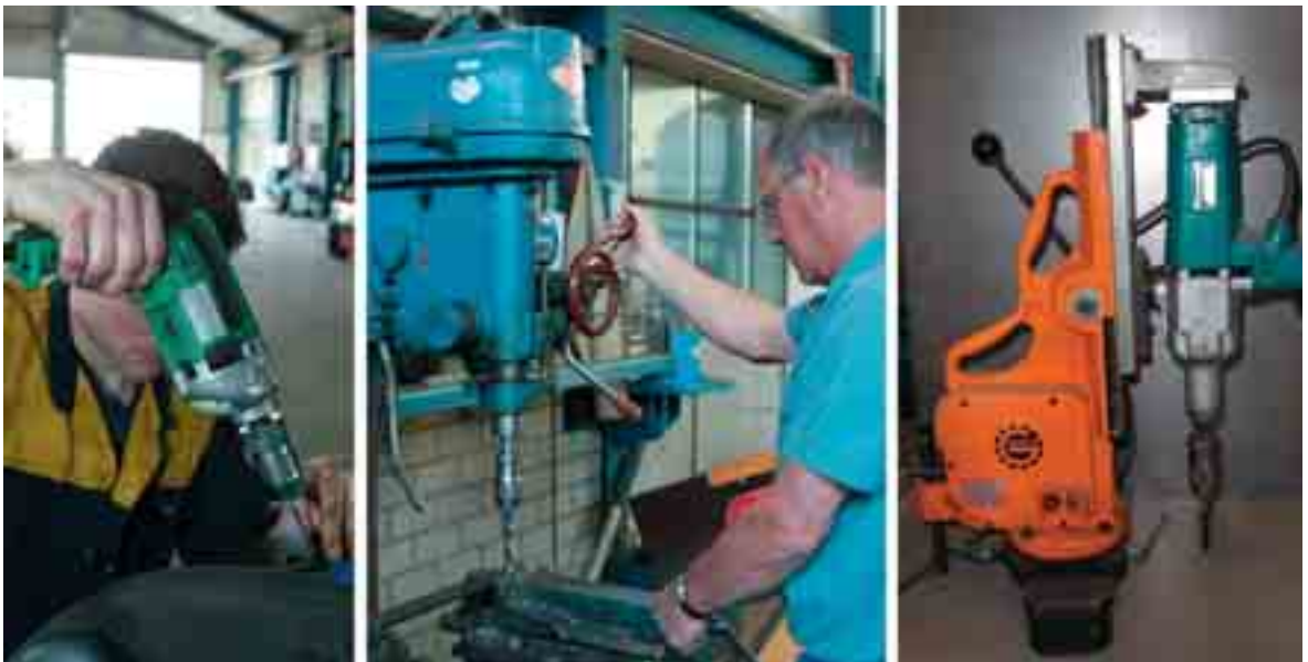
Fig. 1.1 Van links naar rechts: een elektrische handboormachine, een kolomboormachine en een boormachine met magneetvoet
