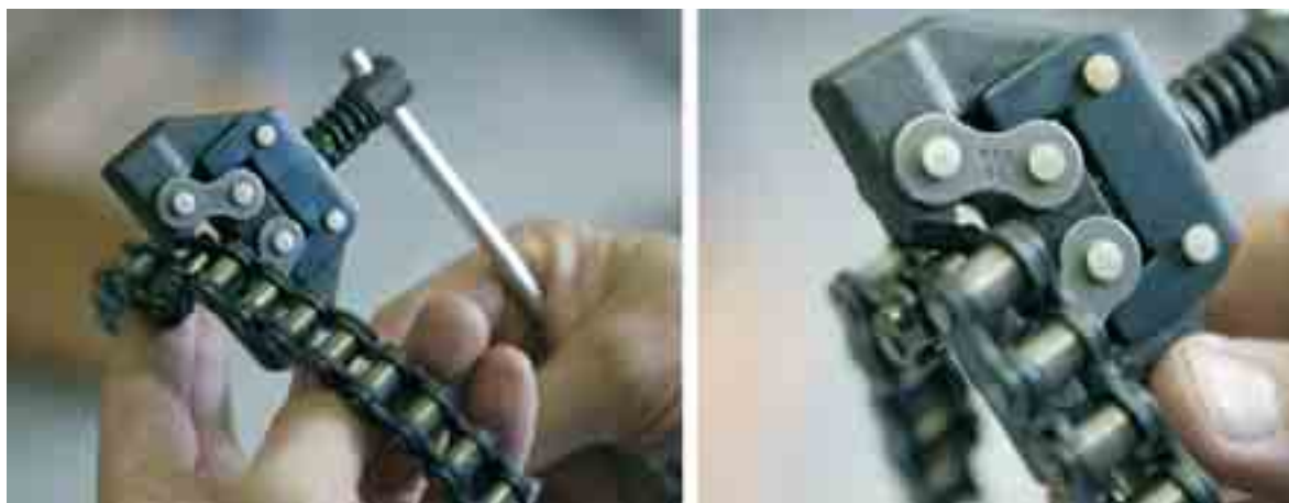
Fig. 14.21 Het splitsen van een ketting met de kettingsplitser
