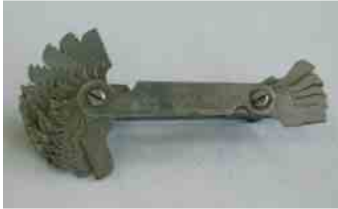
Fig. 3.1 Met een schroefdraadmeter meet je het schroefdraad op.
