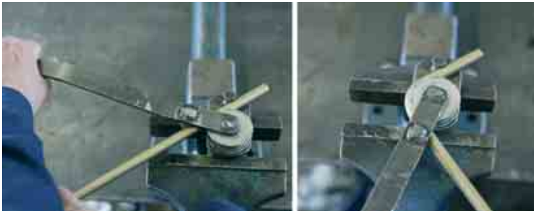
Fig. 6.1 Buigijzer in de bankschroef voor het buigen van hydrauliekleidingen
