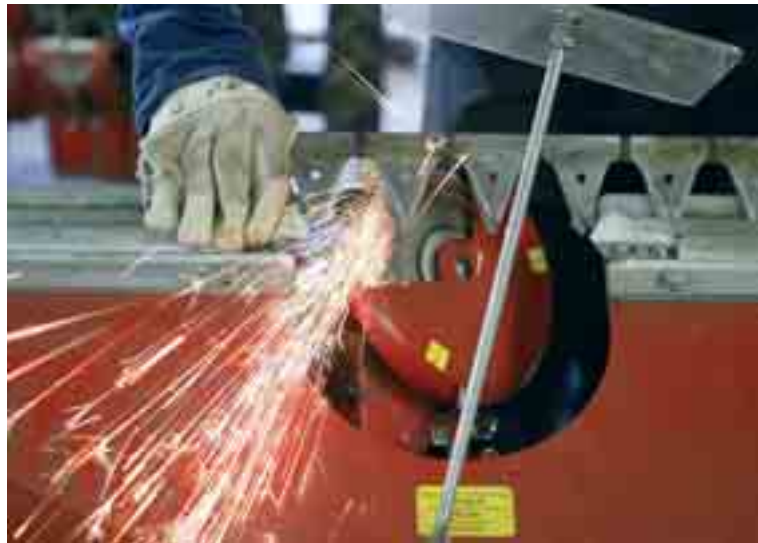
Fig. 4.9 Bij het slijpen met een speciale slijpmachine kun je de hoek exact instellen.
