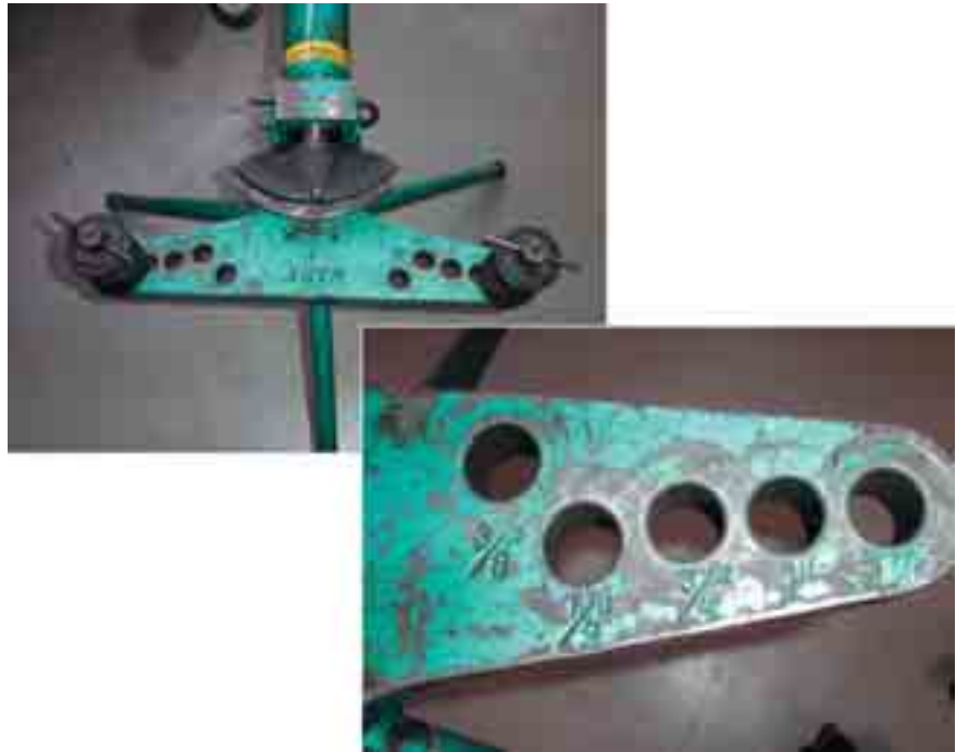
Fig. 6.7 De hoekmallen moeten in de juiste gaten geplaatst worden.
