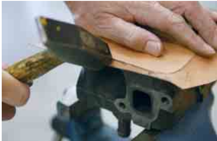
Fig. 9.2 Het maken van een nieuwe pakking uit speciaal pakkingmateriaal
