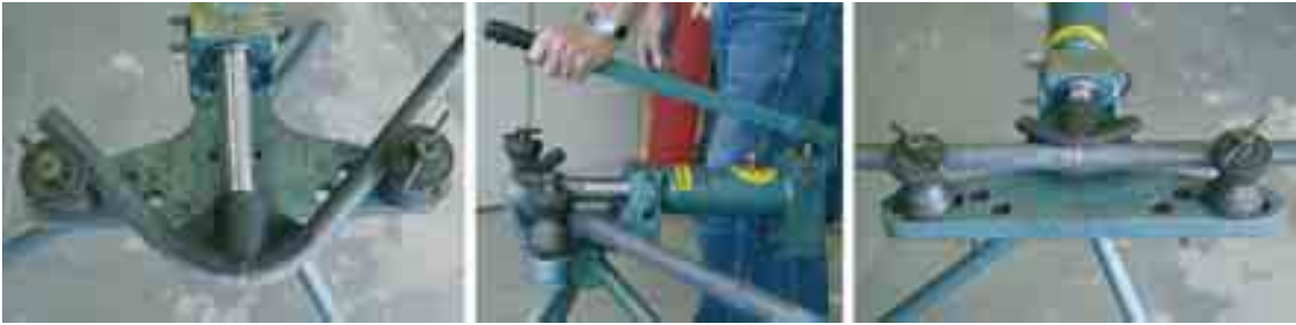
Fig. 6.4 Het buigen van een pijp ijzer in een buigmachine
