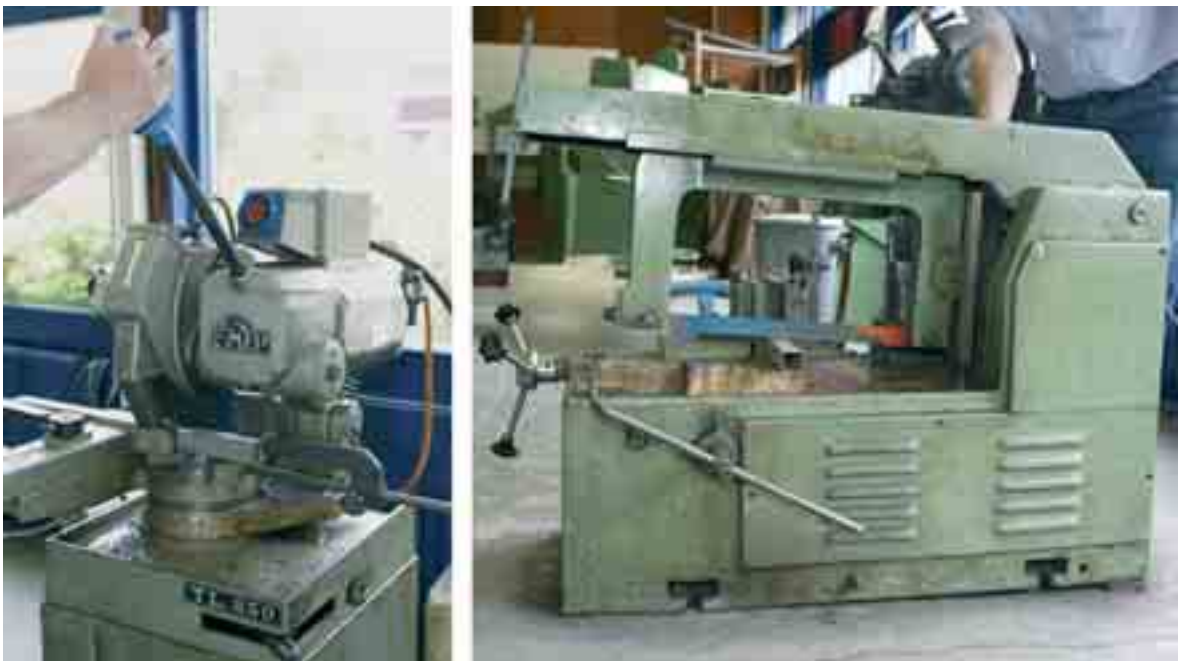
Fig. 2.1 Een cirkelzaag (links) en een beugelzaagmachine (rechts)
