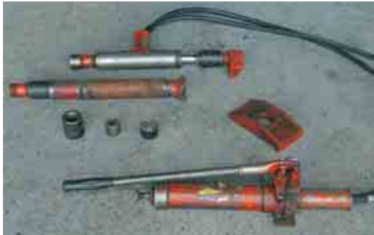
Fig. 14.1 Draagbare hydraulische pers met hulpstukken
