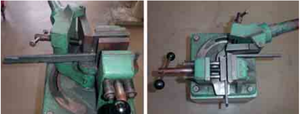
Fig. 5.8 Hoekbuigmachine met een te buigen strip ijzer
