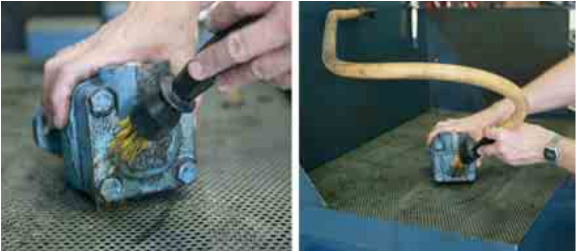
Fig. 14.20 Het ontvetten van een te repareren onderdeel
