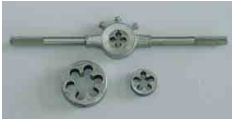
Fig. 3.3 Vast en nastelbaar snijraam met snijplaten
