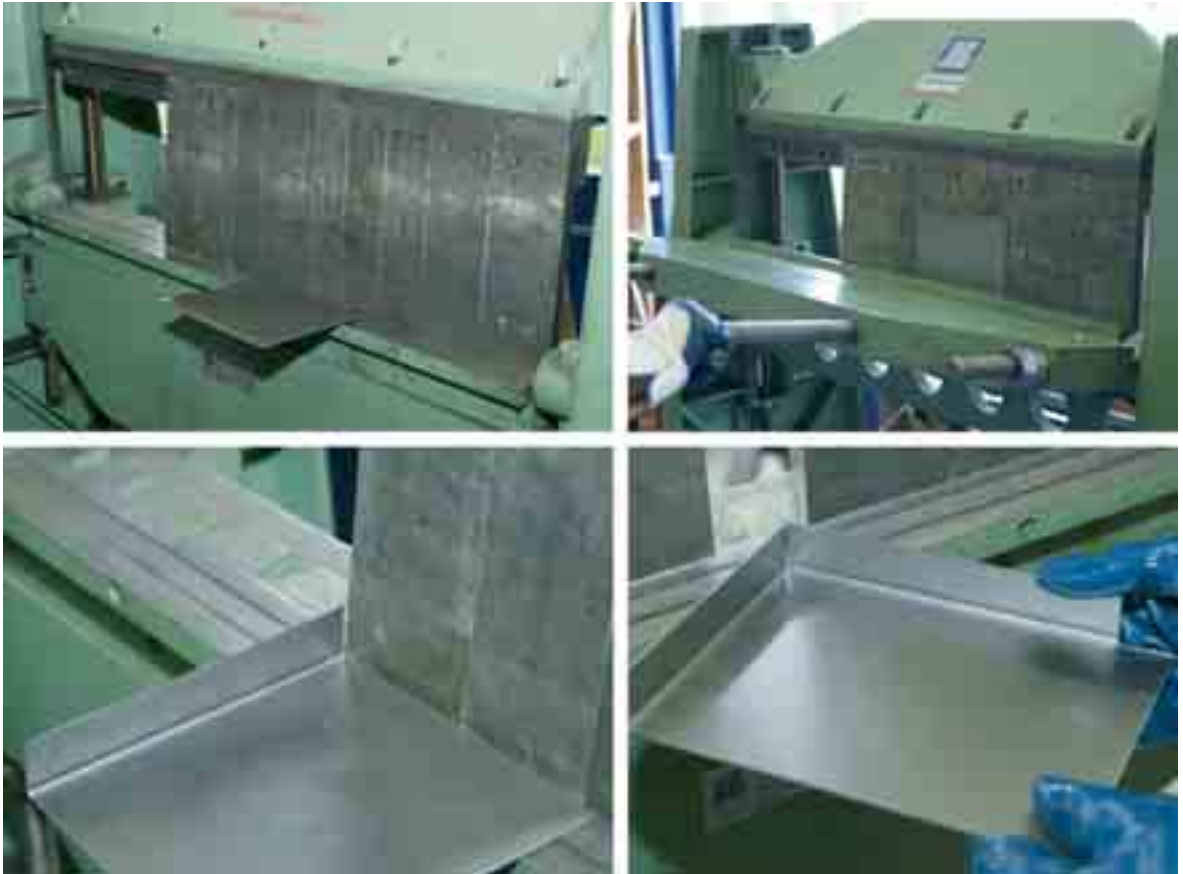
Fig. 5.5 Werking van de zetbank
