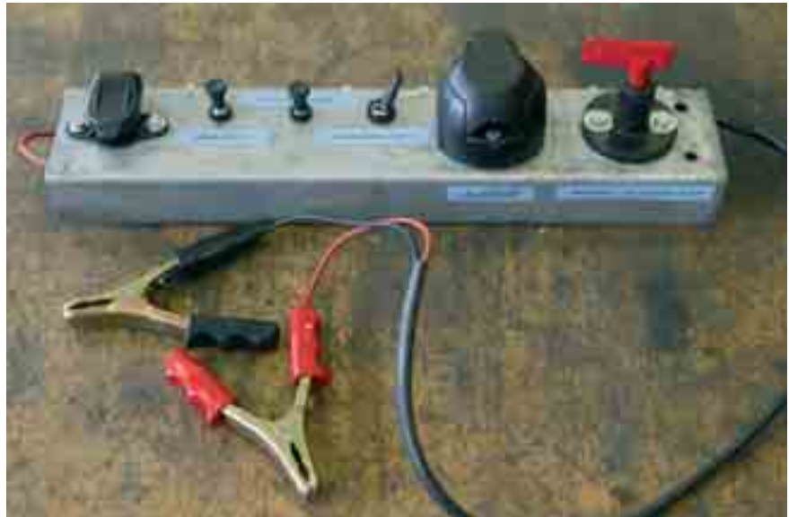
Fig. 14.7 Testbalkje voor wagenverlichting
