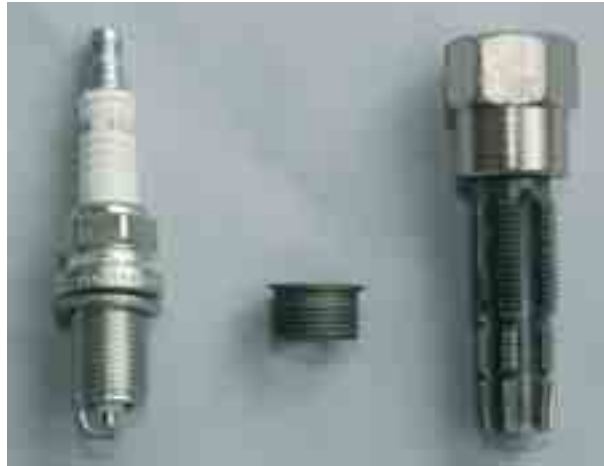
Fig. 3.10 Speciale reparatieset voor het repareren van schroefdraad in een bougiegat
