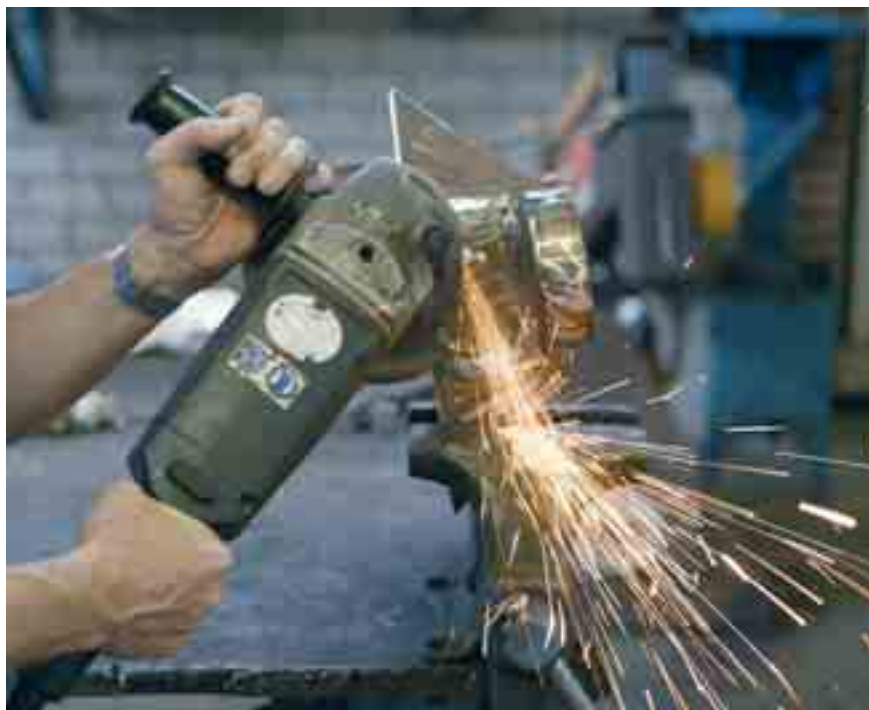
Fig. 4.4 Het werken met een haakse slijpmachine. Denk aan de veiligheid!
