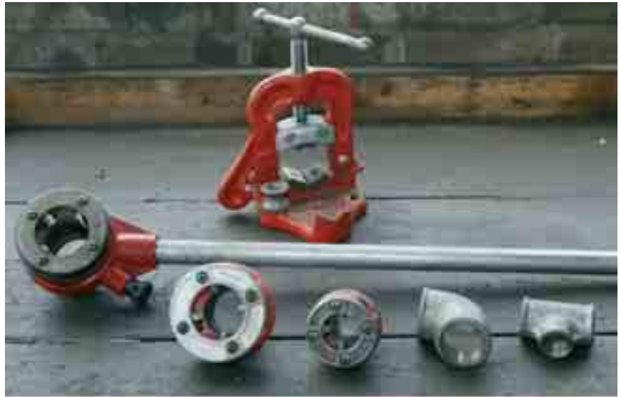
Fig. 3.7 Enkele snijramen, koppelmateriaal en een speciale buizenklem
