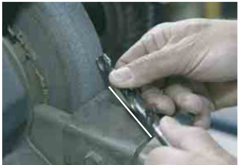
Fig. 1.10 Beide hoofdsnijkanten moeten dezelfde hoek maken en dezelfde lengte hebben. Op de leunspaan kun je de hoek aangeven.
