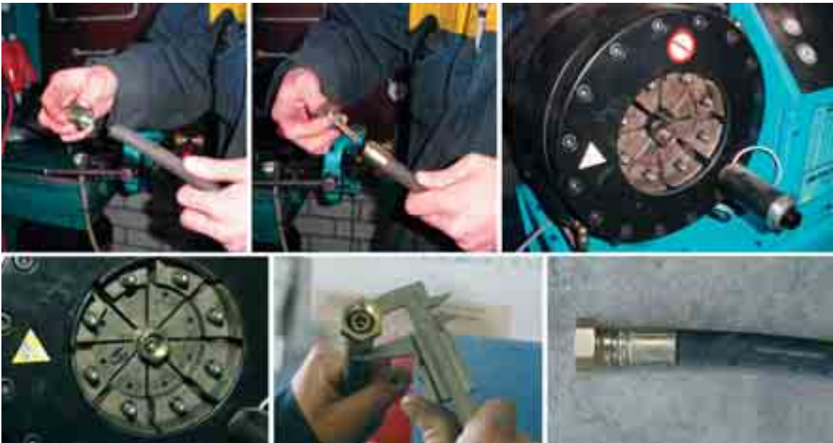
Fig. 13.6 Koppeling aan een slang zetten
