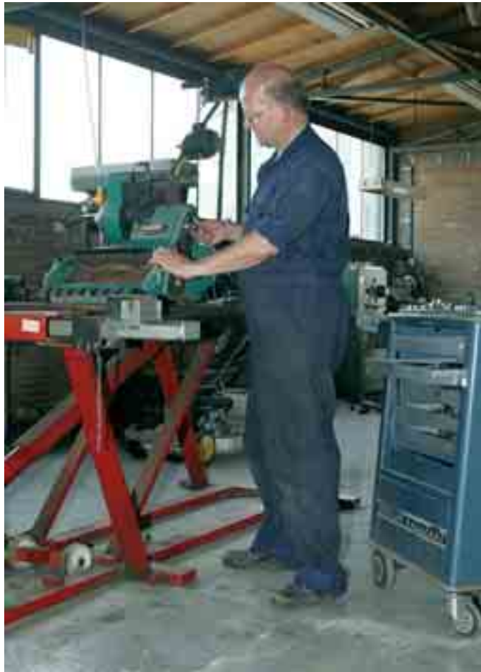
Fig. 14.3 Een heftafel op de juiste hoogte spaart de rug van de monteur.
