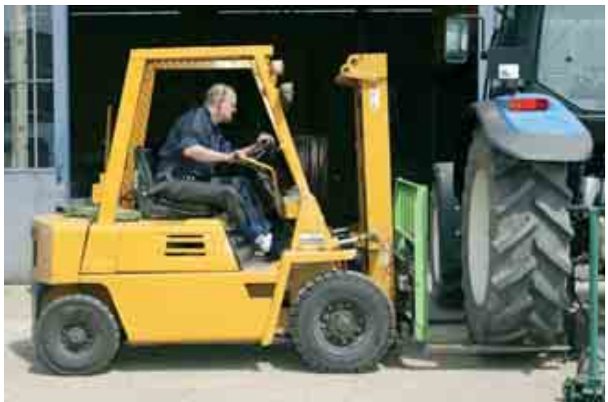
Fig. 14.4 Als je geen bandenlift hebt, kun je ook een heftruck gebruiken voor het verwijderen van een trekkerband.
