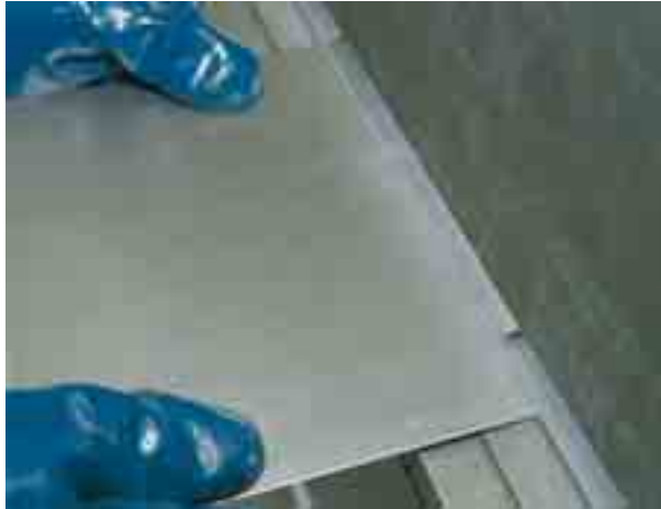
Fig. 5.6 Juiste instelling van de buigbalk en liniaal
